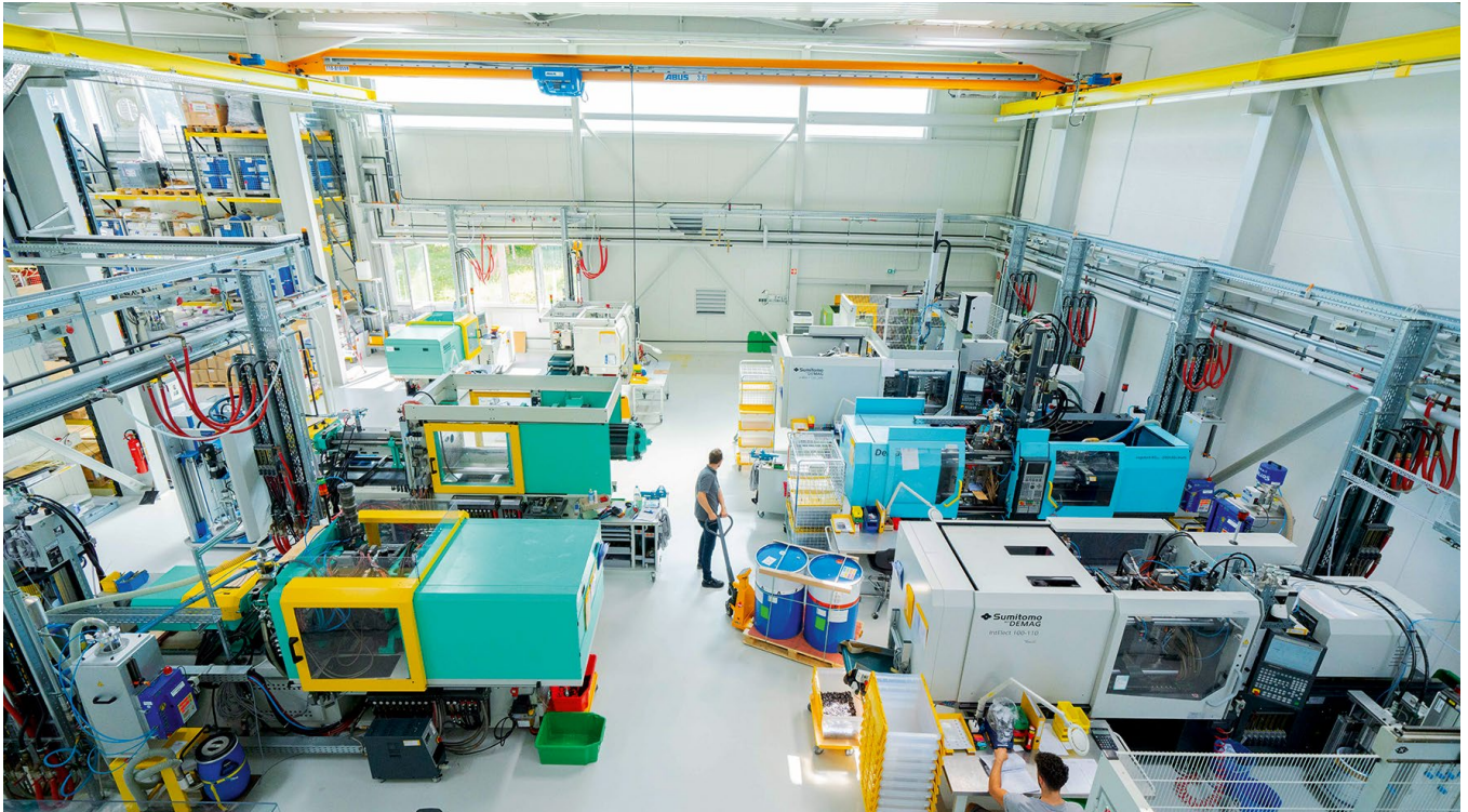
▲ Auf dem Maschinenpark werden 1K-Silikonbauteile mit Gewichten von 1 bis maximal 200 g und 2K- bis 5K-Teile gefertigt.
